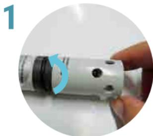
Desenroscar la protección de la sonda Multi Ion.
