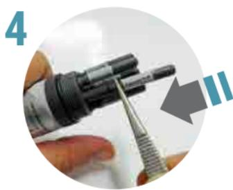
Sujetar el nuevo sensor con las pinzas e introducir, por el extremo del conector dorado, en el canal deseado
