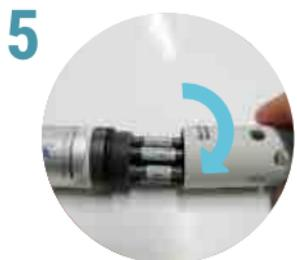
Enroscar la protección sin tocar la punta de los sensores.
