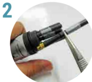
Extraer el sensor a reemplazar con las pinzas.
